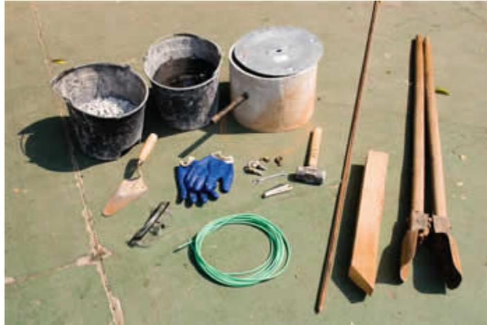
**Caixa de inspeção, haste cobreada com diâmetro 5/8" (15 mm) e 2,40 m, conectores do tipo cabo haste ou do tipo grampo, condutor na cor verde-amarela ou verde, terminal à pressão, balde com água, um pedaço de caibro, marreta, chave de boca 13 mm, canivete, colher de pedreiro, cavadeira, brita e EPI's (luvas, óculos e capacete).**
