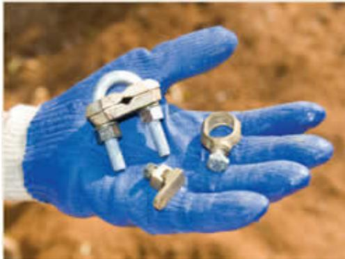
**Os conectores do tipo cabo haste devem ser usados para condutores de secção até 35 mm<sup>2</sup> e os do tipo grampo, para condutores de secção acima de 35 mm<sup>2</sup>.**
